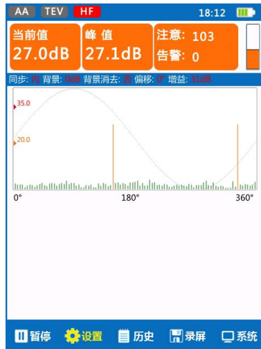
图 3.2 高频检测相位直线图谱
