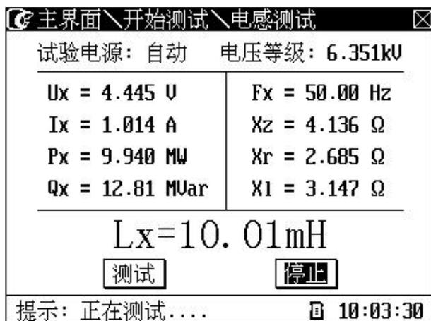
在**电感测试**界面，按<存储>键可将当前测试结果保存到本机内存中，按<打印>键打印当前试验参数及测试结果。
