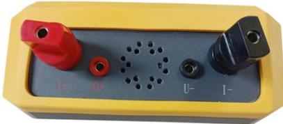
I+、I-：电流输出接线柱。
