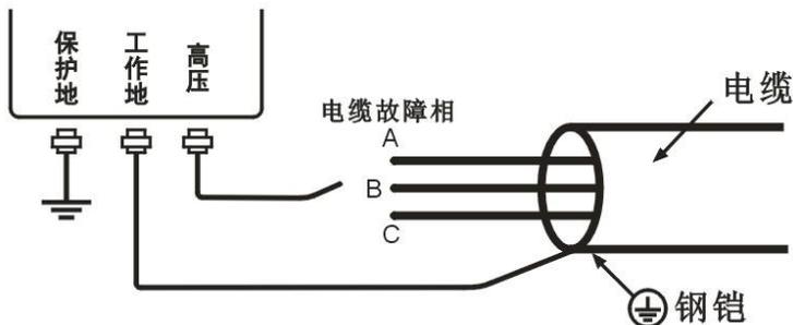
图 3-1-1 相地故障接线示意图
