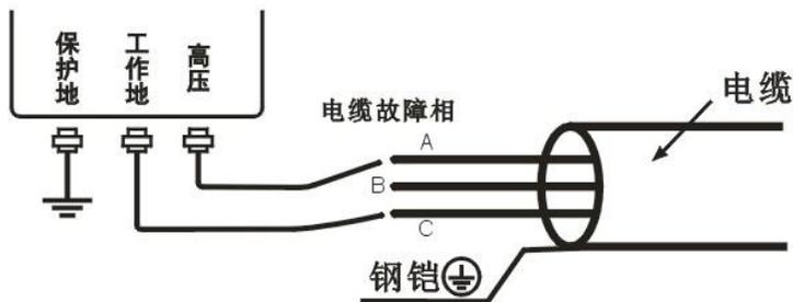
图 3-1-2 相间故障接线示意图
