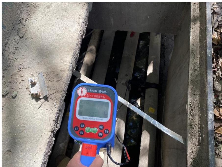
图 B 电缆带电识别现场
