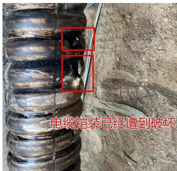
图 B 受外力破坏的故障电缆
