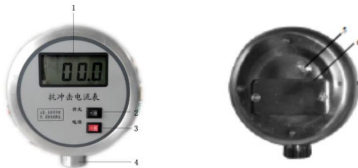
1、带绿色背光源显示窗口。2mA 量程时：最大显示 1999 uA。20mA 量程时：最大显示 19.99 mA。
