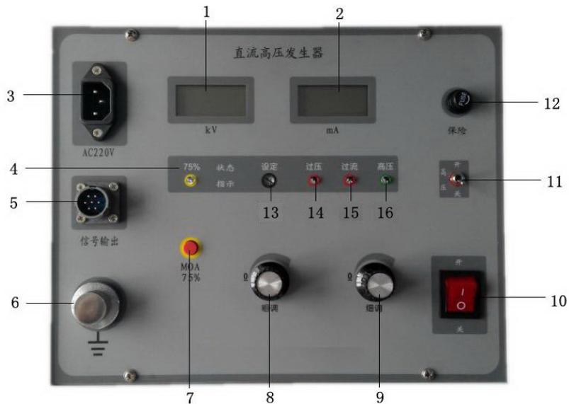
1、电压表：显示输出电压，显示单位：kV, 最大显示 999.9 kV。
