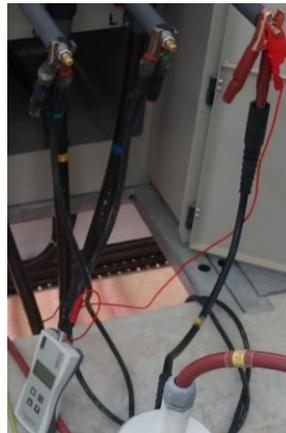
图 25 局放校准器和电缆终端连接示例
