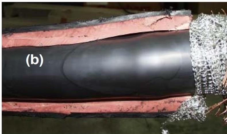
图 68 XLPE 电缆的局放检测例(b) 由于不完全收缩引起的应力管与绝缘管间的间隙
