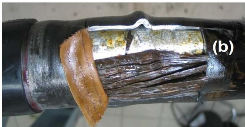
图 66 PILC 电缆中检测到的局放，强烈的内部弯曲造成机械损伤
