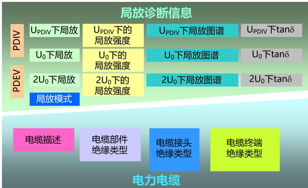
图 60 8 个基本知识要素：局放诊断信息（上）；电力电缆技术信息（下）
