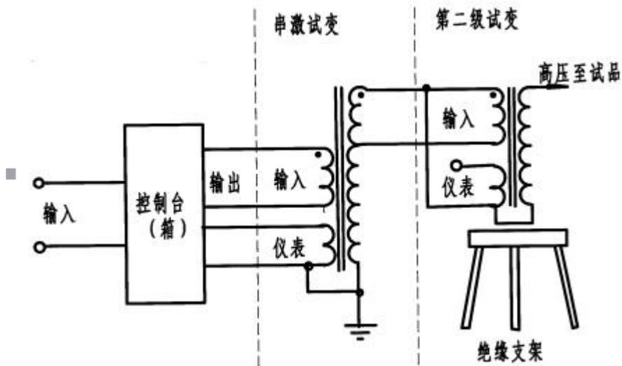
串激试验接线示意图
