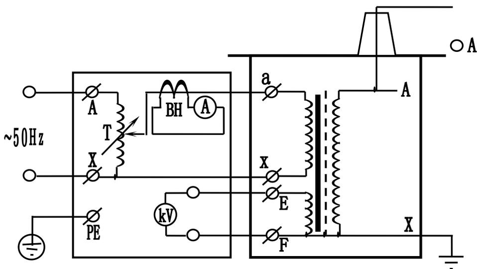
图 1：控制箱工作原理
