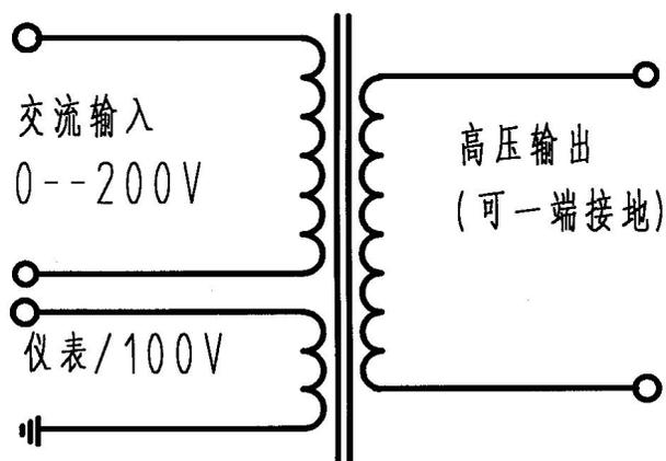
全绝缘试验变压器结构图。试验接线方式根据不同的试验要求决定试验接线方法。
