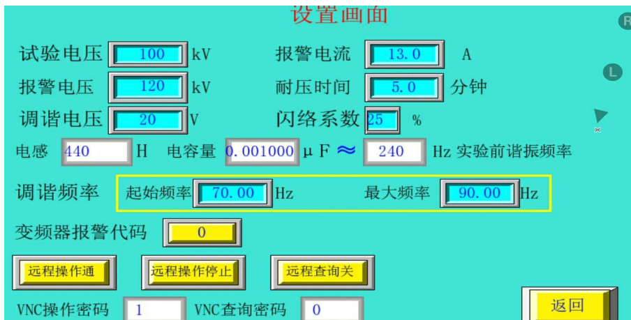
试验前谐振频率计算结果值图 2-12
