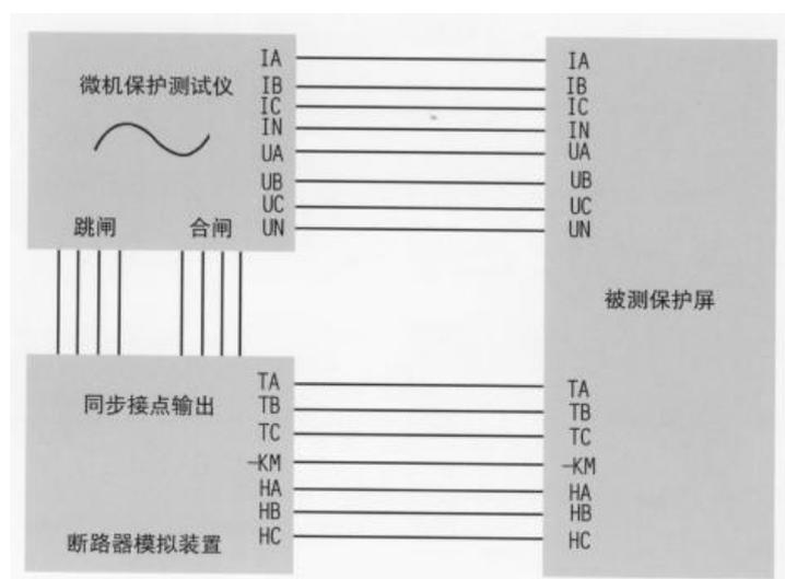
**注意事项: 禁止将模拟断路器的输入输出接反。**
