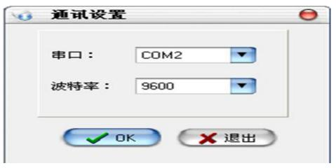
点击"**连接设备**",软件主界面左下角会提示"设备已连接";如果"提示设备已断开",请 检查连线和通讯设置是否正确。
