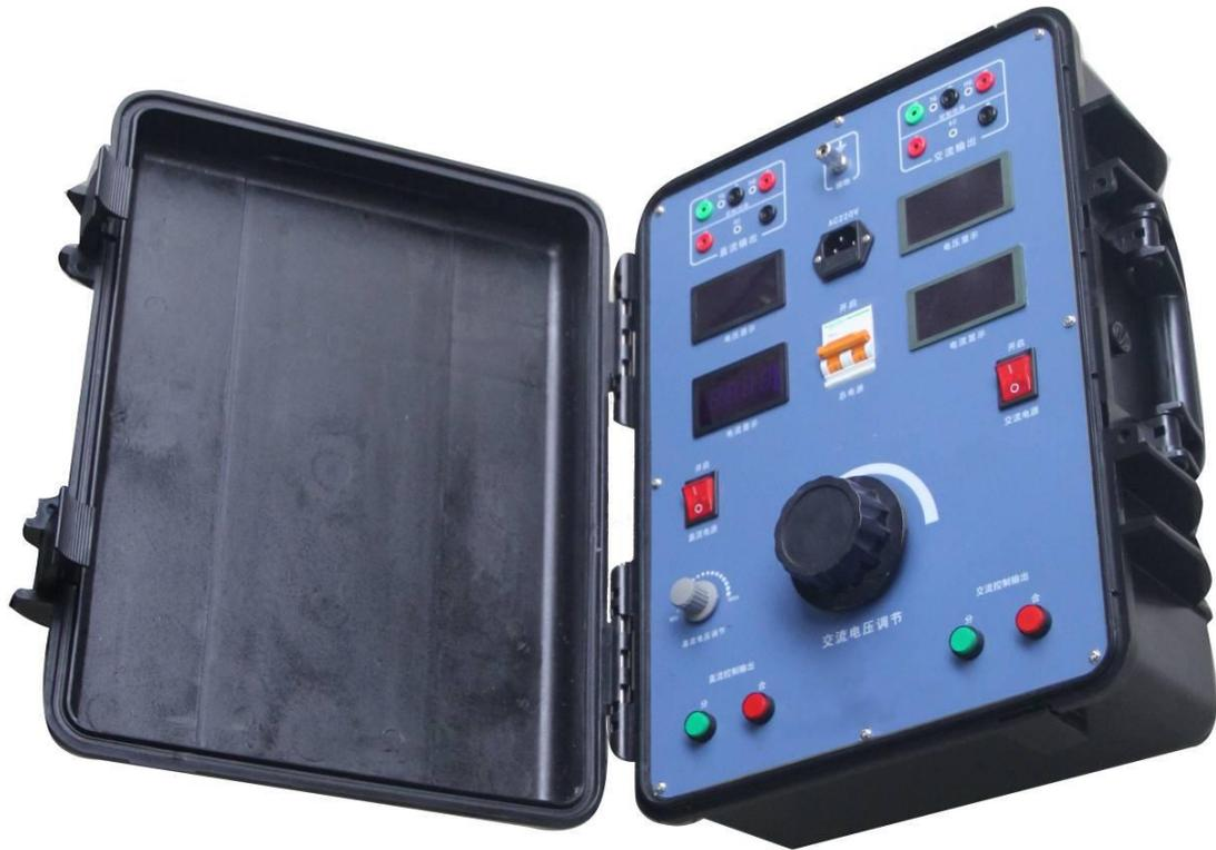
电源插座：交流电源输入，自带保险丝 15A；
