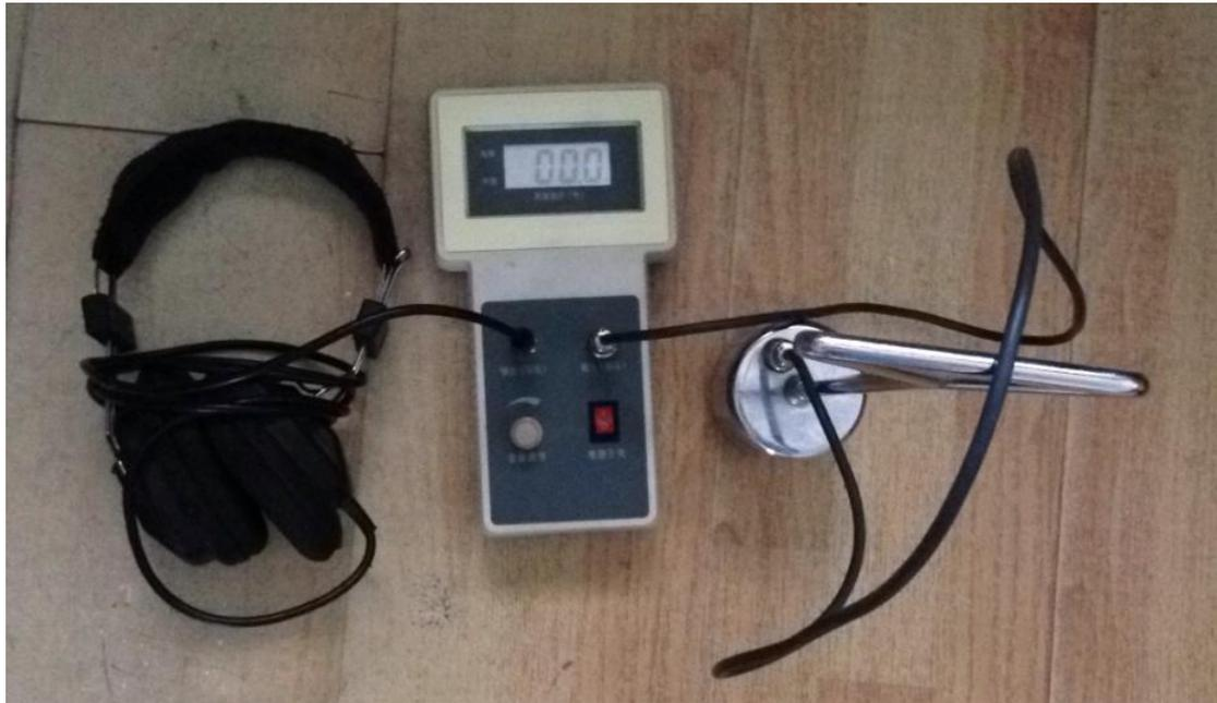
电缆故障定点仪配备了一流的集成电路和放大器。在声音通道上的过滤装置最大限度地去除干扰噪音，同时增强电弧产生的声音。液晶显示屏可同时显示声音脉冲和磁脉冲以及故障点距探头测试点的距离。
